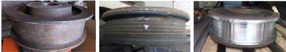
ნახ.3. დადუღებით აღდგენილი გოგორათვალის: ა-დასადუღებელი გოგორათვალის; ბ-ფლუსის საფარში დადუღების შემდეგ; გ-მექანიკური დამუშავების შემდეგ.
