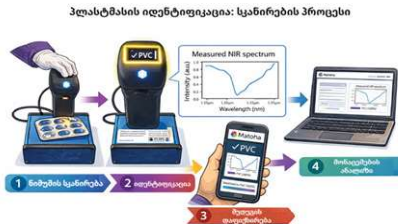
სურ. 3. მასალების იდენტიფიკაციის სამუშაო სქემის სქემატური წარმოდგენა ხელში დასაჭერი ინფრაწითელი (NIR) სპექტროსკოპიის გამოყენებით.
