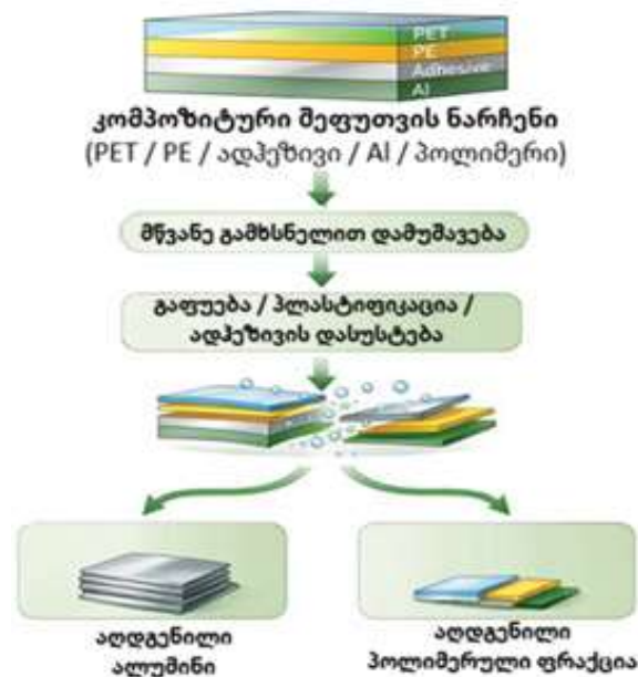
სურ. 2. ალუმინ-პოლიმერული კომპოზიტური შეფუთვის ნარჩენების მწვანე გამხსნელებზე დაფუძნებული განცალკევების სქემატური წარმოდგენა.
